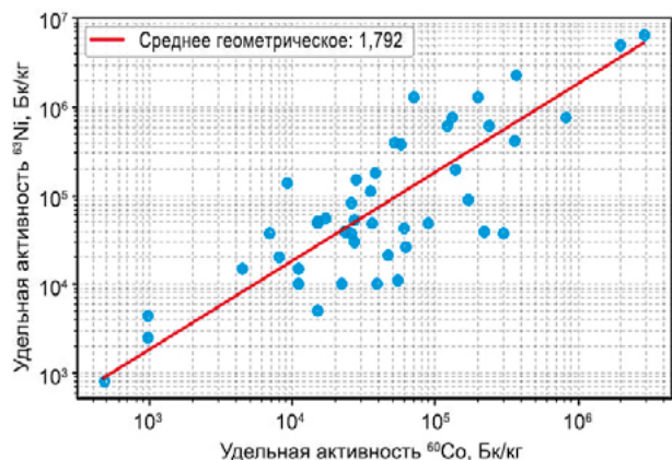
Рис. 4. Диаграмма рассеяния для соотношения удельных активностей ^{63}\text{Ni} и ^{60}\text{Co} в ТРО энергоблоков № 1 и 2 Нововоронежской АЭС
