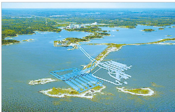
Рис. 4. Проект расширения действующего ПЗРО для НАО и САО (новые секции выделены синим цветом) [3]
