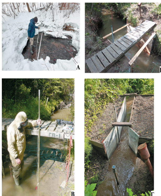
Рис. 2. Гидрологические наблюдения: А — измерение расхода воды в конце зимней межени на р. Байкал; Б — общий вид гидропоста ГП-5 на руч. Меркурьев; В — измерение расхода воды на ГП-1, р. Шумиха; Г — общий вид гидропоста ГП-2, руч. Безымянный
