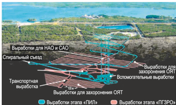
Рис. 2. Схема горных выработок ПИЛ и ПГЗРО ONKALO (Финляндия) [14]
