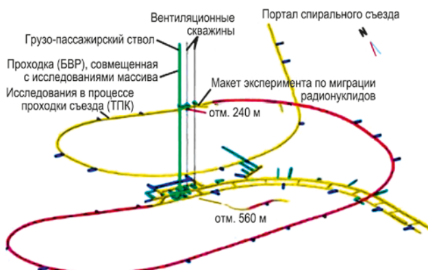
Рис. 2. Схема горных выработок ПИЛ и ПГЗРО ONKALO (Финляндия) [14]
