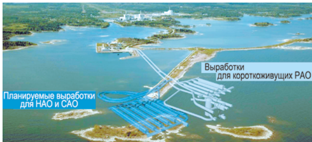
Рис. 7. Схема горных выработок для размещения короткоживущих РАО, а также НАО и САО на глубине до 60 м, проект Forsmark [18]
