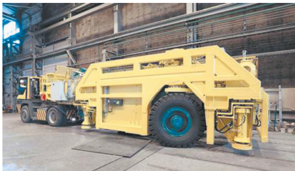
Рис. 14. Прототип устройства для транспортировки по спиральному съезду контейнеров с РАО в ПГЗРО ONKALO [34]
