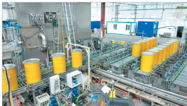
Рис. 2. Экспериментальная модель установки для цементирования РАО в бочках [2]
