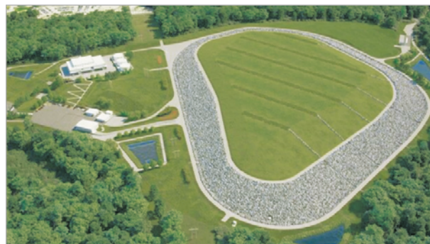
Рис. 3. Эскиз проекта ПЗРО курганного типа на площадке Чок-Ривер (Онтарио) [5]
