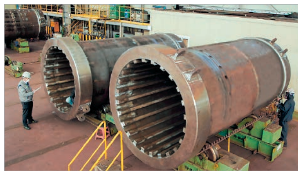
Рис. 4. Процесс изготовления контейнеров для хранения ОЯТ, предназначенных для использования на площадке АЭС Три-Майл-Айленд в США [7]
