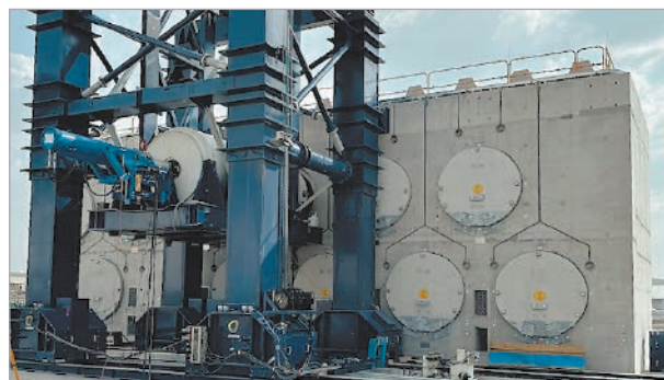
Рис. 5. Процесс загрузки контейнера с ОЯТ в верхний модуль двухуровневой системы сухого горизонтального хранения NUHOMS MATRIX на площадке АЭС Вулф Крик в штате Канзас [8]
