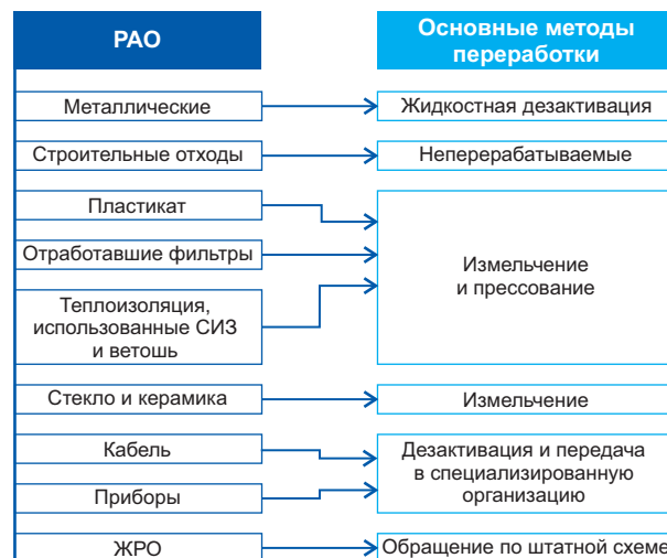
Рис. 5. Основные потоки отходов, образующихся при ВЭ зданий и сооружений ОСУБ РХЗ, и методы их переработки
