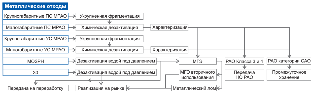
Рис. 6. Укрупненная схема обращения с металлическими отходами, образующимися при ВЭ зданий и сооружений ОСУБ РХЗ
