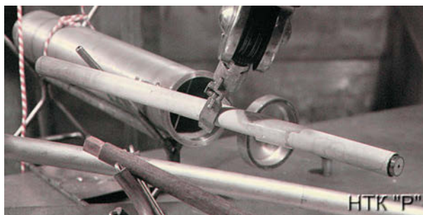
Рис. 2. Отделение концевых элементов ЭГК с помощью машинного манипулятора
