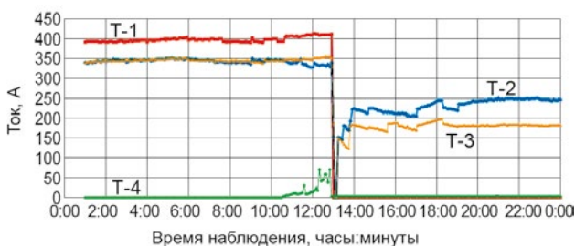
Рис. 7. Ток, подаваемый на электроды плавителя при осуществлении слива стекломассы
