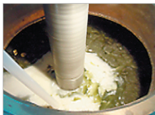
Рис. 1. Процесс отбора керна модельного стекла
