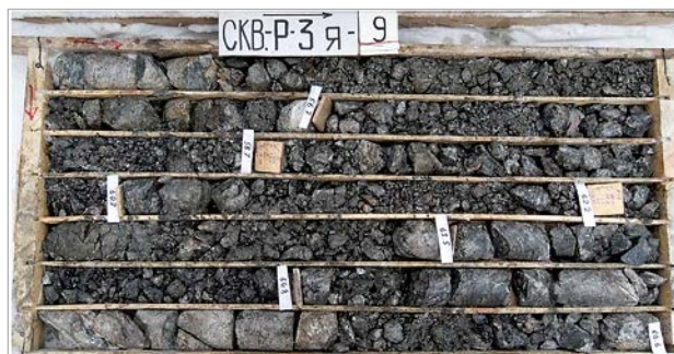
Рис. 3. Зона дробления гнейсов с глинисто-древянным заполнителем (фото свежезвлеченного керна на участке «Енисейский»)
