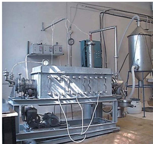
Рис. 4. Горизонтальный кальцинатор разработки АО «ВНИИНМ»
