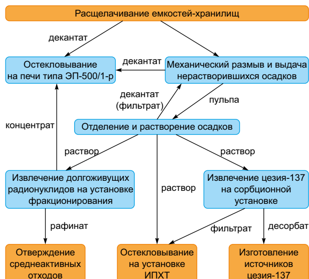
Рис. 1. Вариант технологической схемы переработки накопленных гетерогенных ВАО (1995 г.)
