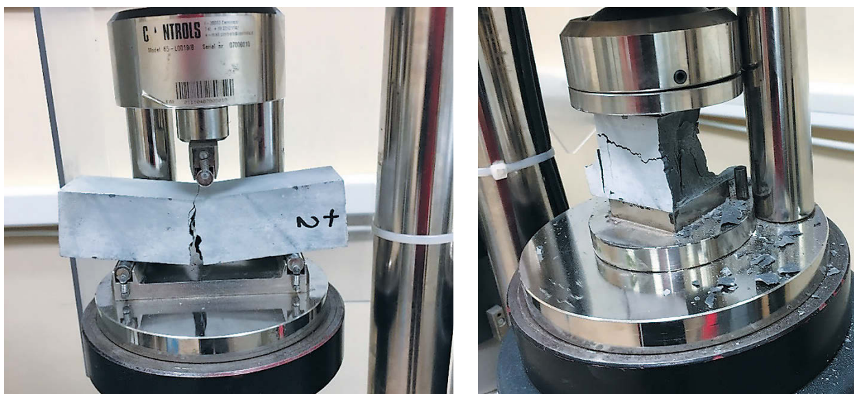
Рис. 3. Определение физико-механических свойств образцов тампонажных материалов
