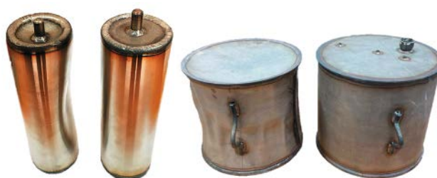
Рис. 3. Изменение объема металлических капсул после ГИП
