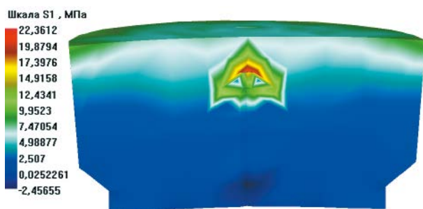
Рис. 9. Распределение максимальных главных напряжений \sigma_1 в герметизированной пробке
