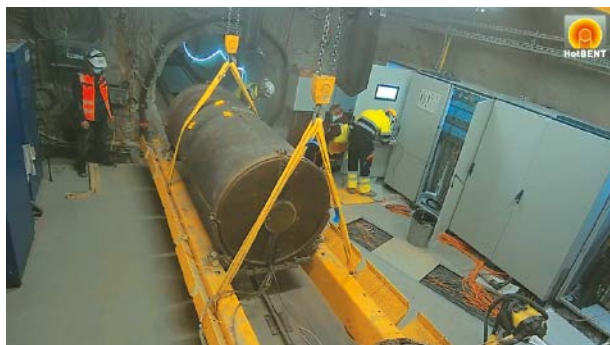
Рис. 4. Фотография с места проведения эксперимента HotBENT, в ходе которого нагревающий элемент был размещен внутри тоннеля подземной исследовательской лаборатории Гримзель
