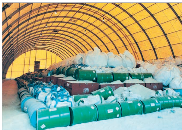
Рис. 2. Технология захоронения ОНРАО объекта Cirex на площадке Morvilliers (Франция) [28]
