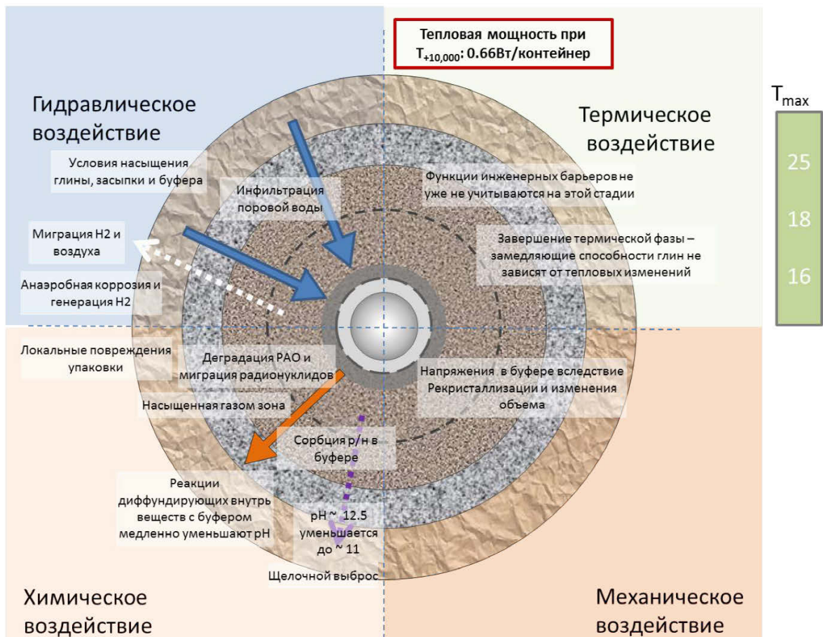
Рисунок 9 – Схематизация процессов, происходящих в ближней зоне захоронения в первые 10000 лет по версии ONDRAF/NIRAS (Бельгия)
