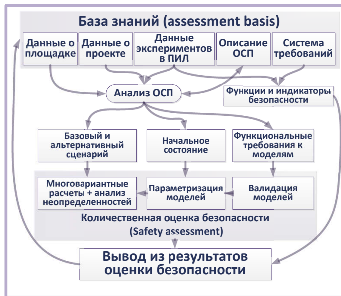
Рисунок 3 – Обобщенная схема работ по формированию Safety case (адаптирована из [19])
