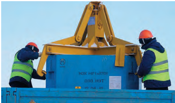
Рис. 1. Зацепление упаковки РАО с использованием полуавтоматического захвата [4]
