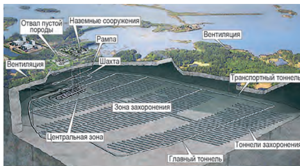
Рис. 7. Модель сооружения захоронения в соответствии с концепцией KBS-3 [24]
