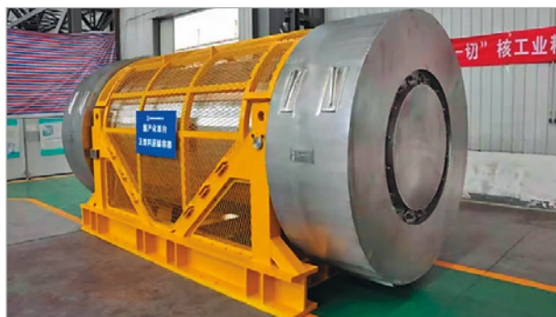
Рис. 2. Первый китайский транспортный контейнер для ОЯТ Longzhou-CNCS [4]
