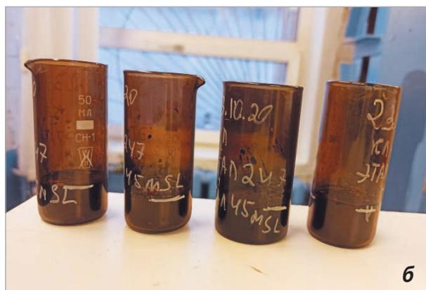
Рис. 5. Внешний вид компаунда на основе клиноптилолита после облучения: а) дозой  $10^6$  Гр, б) дозой  $1,3 \cdot 10^7$  Гр
