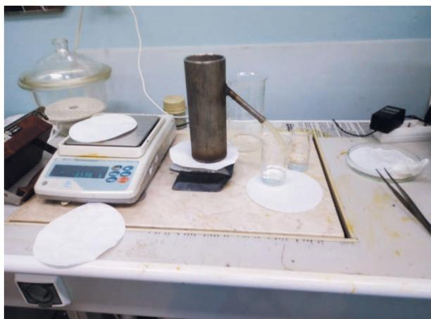
Рис. 2. Рабочее место для измерения объема образцов БСК
