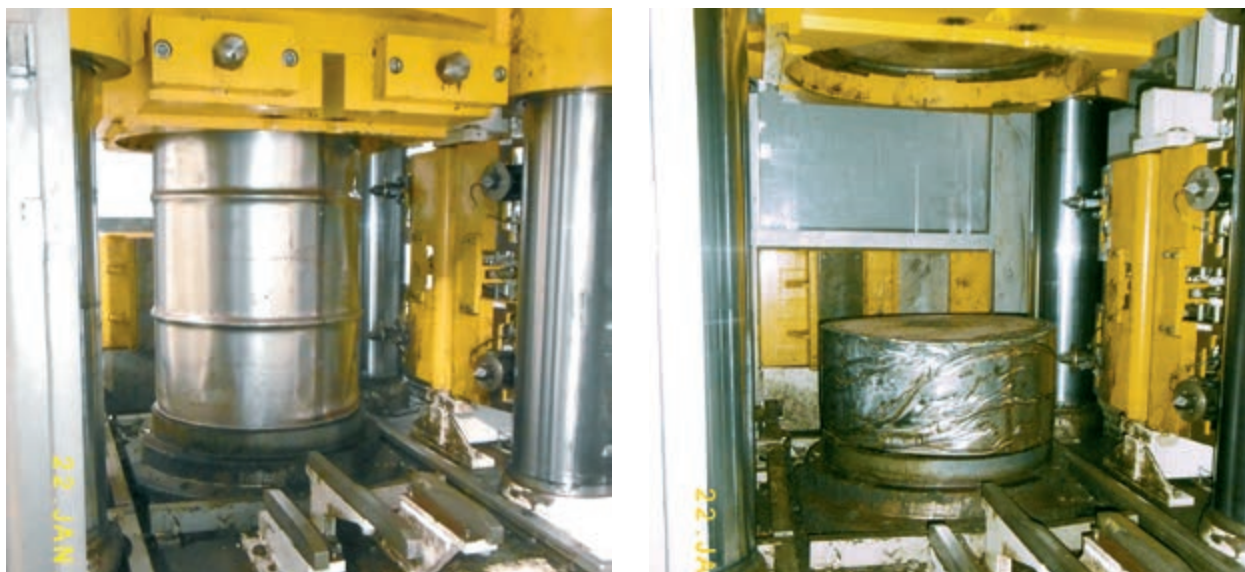
Рис. 3. Бочка с РАО до и после прессования
